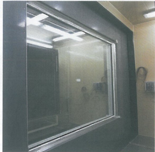
<사진 2> 열관류율 저온측 시험체 모습
