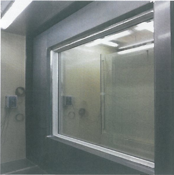
<사진 1> 열관류율 항온측 시험체 모습
